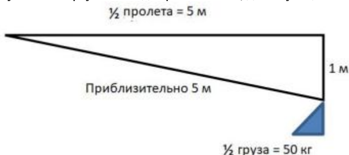
Рисунок 3 – Прямоугольный треугольник для расчетов сил, действующих на троллей
